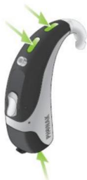
Срок службы защитного фильтра достигает нескольких месяцев и зависит от условий эксплуатации (влажность, запыленность, потоотделение и т.п.). Защитный фильтр нельзя чистить – его нужно регулярно заменять.
