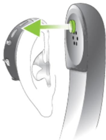
Не прижимайте телефонную трубку к уху. Поместите ее напротив микрофона слухового аппарата, расположенного в его передней части.
