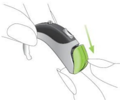
Ногтем приоткройте крышку батарейного отсека, так чтобы она зафиксировалась в положении ВЫКЛ. Помните, что слуховой аппарат Naída является водостойким, поэтому для открывания батарейного отсека надо приложить некоторое усилие.
